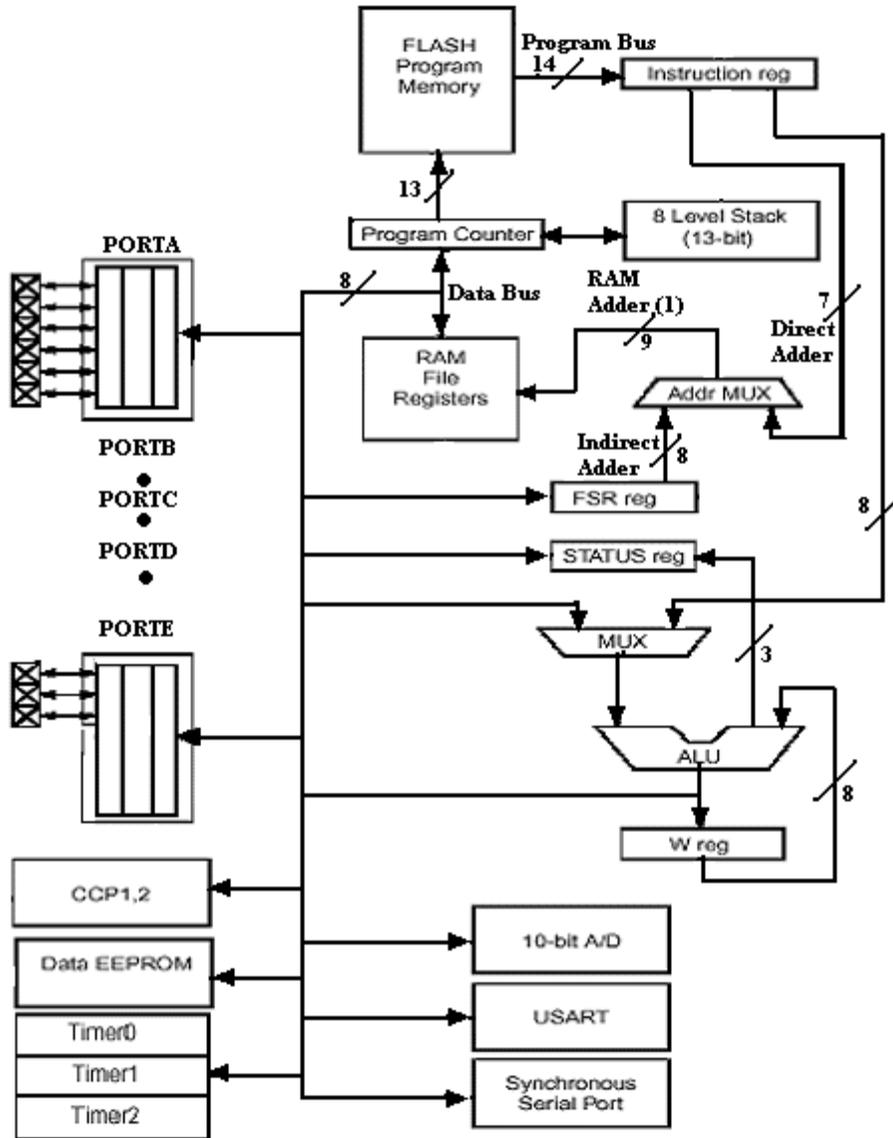
Fig. 2 PIC16F877 Block Diagram
